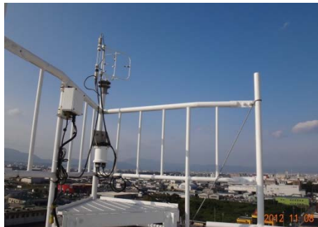
超音波風速計による 乱流観測
